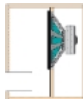
Рис.7. Оформление типа «полосовой фильтр» четвертого порядка
