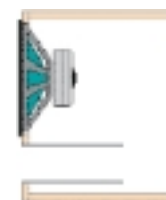
Рис.6. Корпус с фазоинвертором
