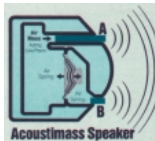
Рис. 11. Низкочастотный блок агрегата Acoustimass
