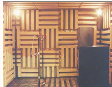
Рис. 2. Измерения микрофонов в заглушенной камере
